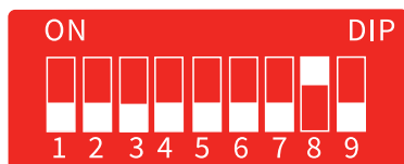
I模式:仅手腕带测量 阈值:手腕带(750K~10MΩ)
