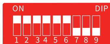
D模式:手腕带+静电鞋同时测量 阈值:手腕带(750K~10MΩ) 静电鞋(750K~1000MΩ)
