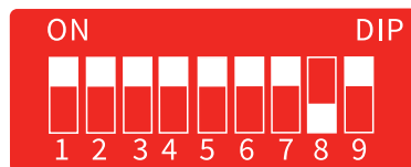
H模式:仅静电鞋测量 阈值:静电鞋(750K~1000MΩ)
